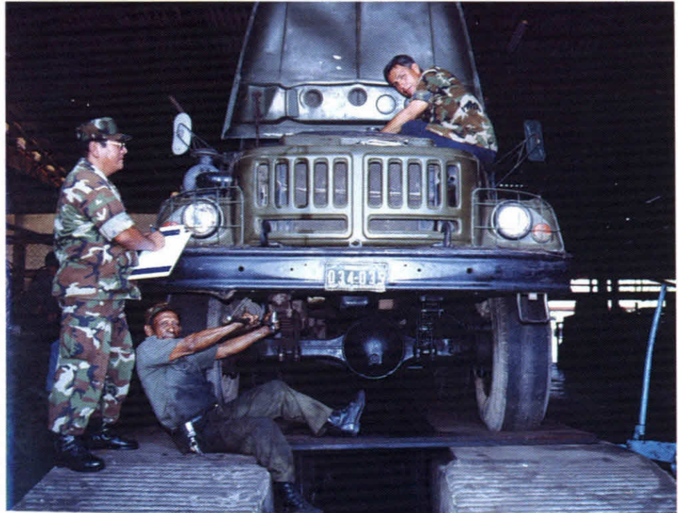
Remotorización de camiones de fabricación Rusa con motores Mercedes Benz
